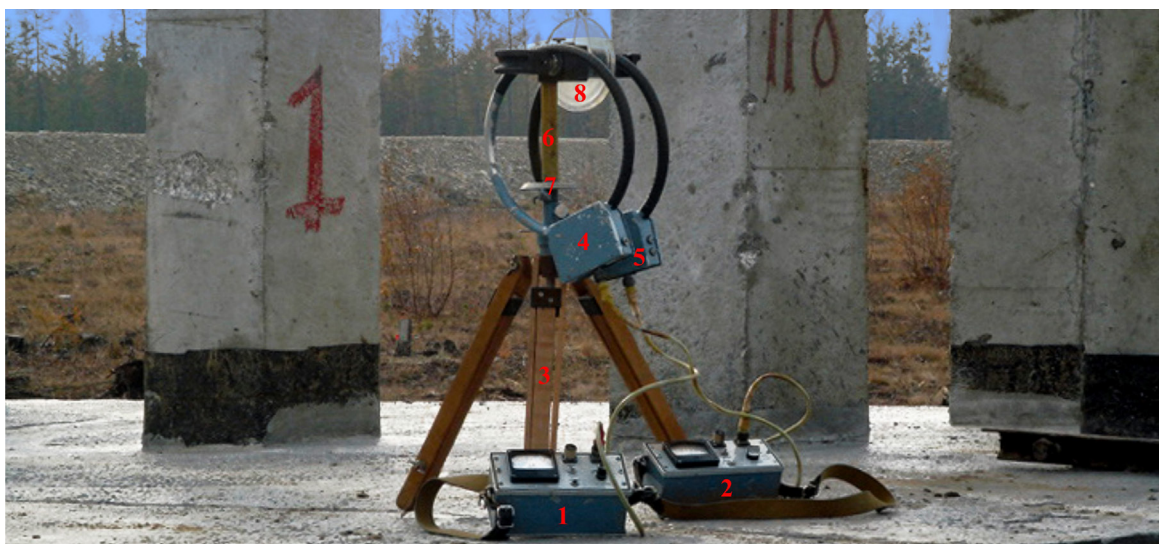
Рис. 1. Аппаратура «СЭМЗ»: 1 – блок питания и регулировки тока в излучающей антенне; 2 – микровольтметр; 3 – штатив; 4 – приёмная антенна для работы на частоте 1,125 МГц; 5 – излучающая антенна с переключателем частоты 2,250 на 1,125 МГц; 6 – стержень угломерного устройства; 7 и 8 – лимбы для измерения горизонтального и вертикального угла эллипса поляризации поля ВВМД. Фото автора.
