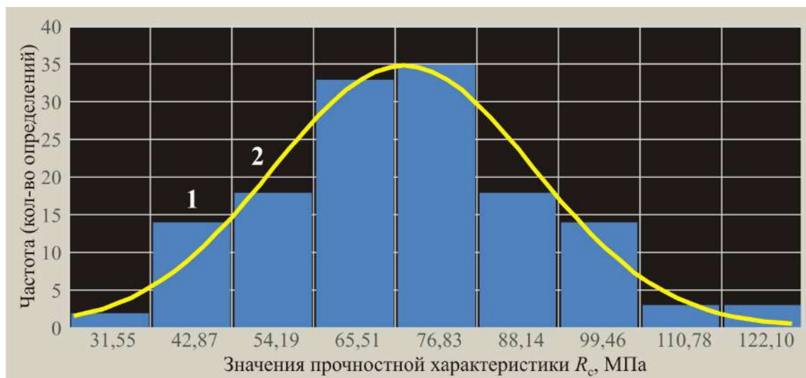
Рис. 1. Графики фактической гистограммы (1) и теоретической вариограммы закона нормального распределения значений прочности осадочных пород Южной Якутии. Объём выборки – 140 определений.
