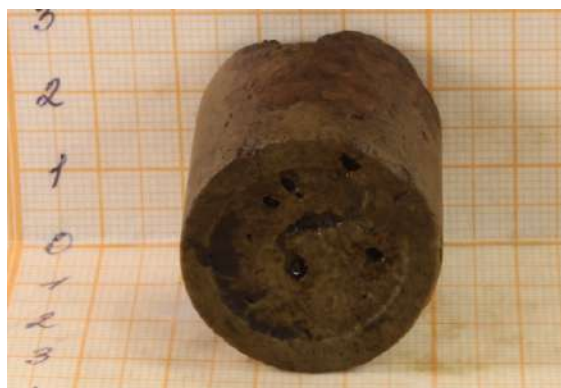
Рис 2. Селективность воздействия кислоты Компонекс-21 v.3 на низкопроницаемый анкерит при T=25 °C (керна месторождения Оренбургской области)
