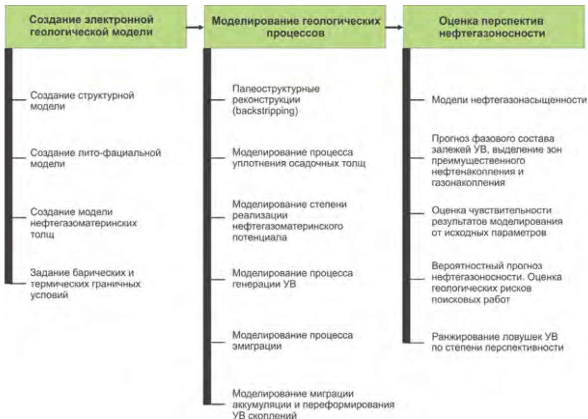
Рис. 2. Схема реализации технологии бассейнового моделирования
