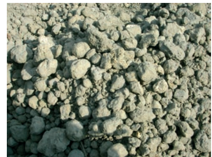
Рис. 3. Окатыши из текущих хвостов обогащения медноколчеданных руд
