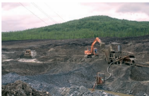
Рис. 2. Промывочный прибор ПБШ-40 (ЗАО «Хэргу», Амурская область)
