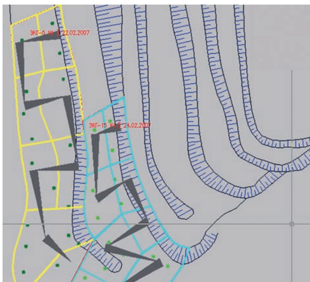
Рис. 2. План развития горных работ с использованием системы управления качеством добываемого полезного ископаемого
