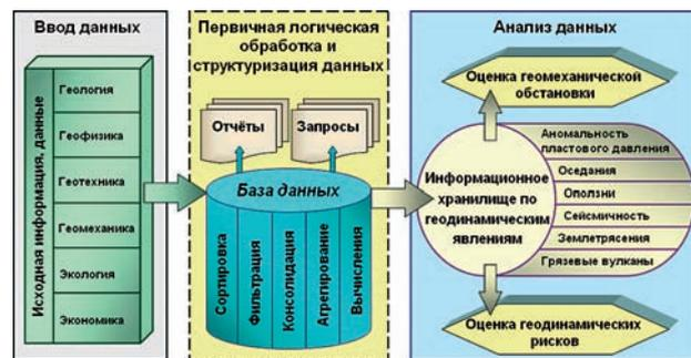
Рис. 2. Информационно-логическая структура автоматизированной базы геомеханических данных
