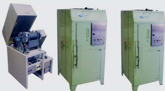
Рис. 3. Линия пробоподготовки № 1. Модуль Бойд – делитель – Одноярусная непрерывная мельница с делителем – Двухъярусная непрерывная мельница с делителем
