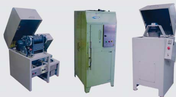
Рис. 4. Линия пробоподготовки № 2. Модуль Бойд – делитель – Одноярусная непрерывная мельница с делителем – Стандартная мельница
