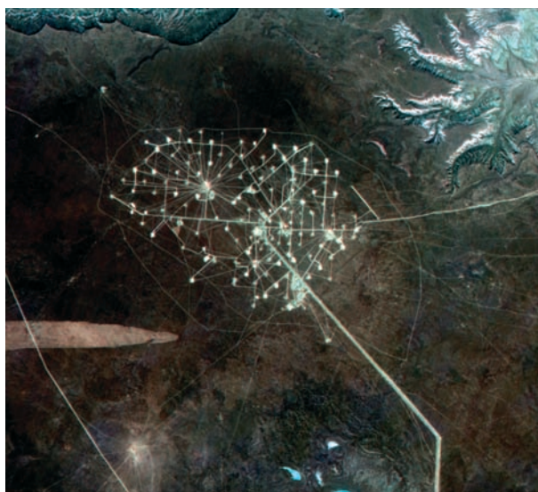
Рис. 3. Факелы месторождения в Мангыстау, Казахстан (выделены красными кружками) по данным датчика LISS-3, синтез RGB 421, разрешение 23 м
