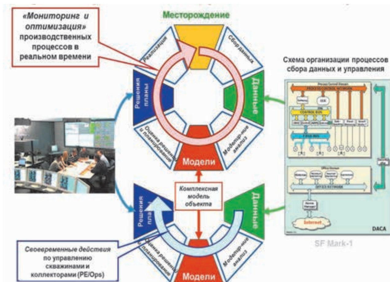
Рис. 1. Взаимосвязь между осуществлением процессов мониторинга и оптимизации в режиме реального времени и своевременностью действий по управлению скважинами и коллекторами
