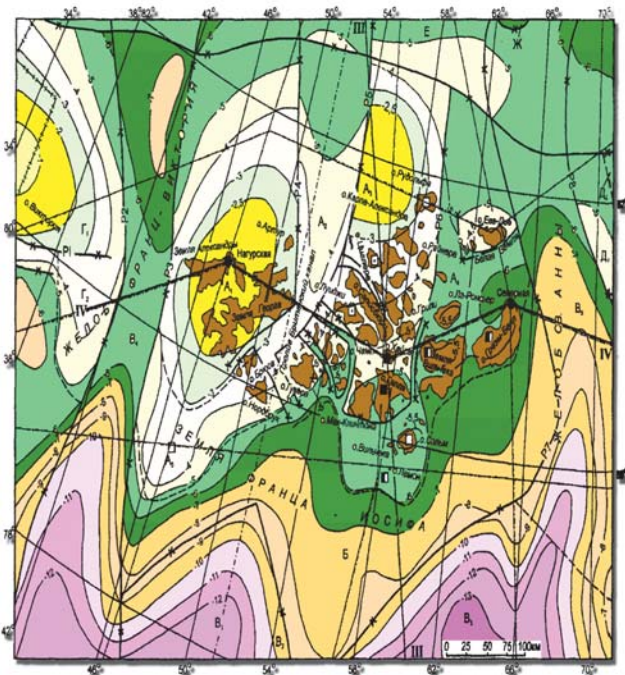
Рис. 1. Антеклиз Франца-Иосифа. Структурная схема по поверхности позднепротерозойского фундамента и направленные геологоразведочных работ
