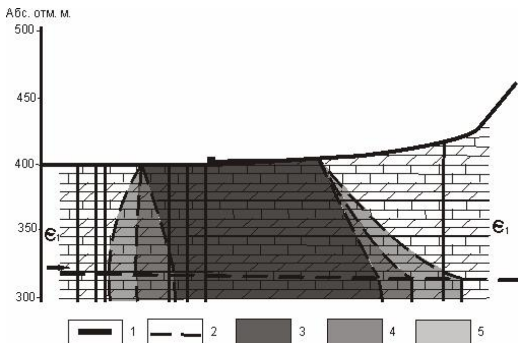
Рис. 1. Геохимическая аномалия цианидов в подземных водах (Куранахская ЗИФ) 1 – хвостохранилище ЗИФ; 2 – уровень подземных вод; 3-5 – концентрация цианидов в подземных водах, мг/л: 3 – 0,5, 4 – 0,3, 5 – 0,05
