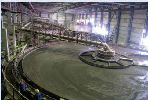
Отделение сгущения флотационной обогатительной фабрики
