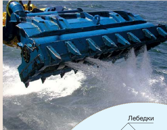
Рис. 3. Грунтозаборное устройство конструкции РГРУ
