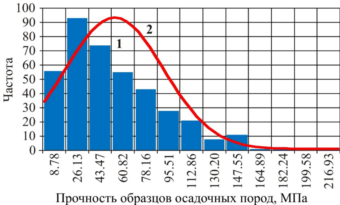
Рис.3. Модель вероятностного распределения по лабораторным данным прочности осадочных пород Южной Якутии по всем участкам инженерно-геологических изысканий: 1 – гистограмма; 2 – вариограмма закона Вейбулла. Объем выборки – 430 определений.
