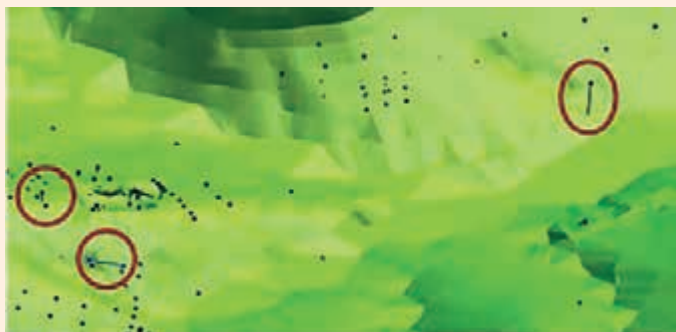
Рис. 3. Пример ошибок в координатах устьев скважин
