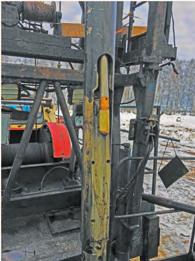
Рис. 3. Автономный инклинометр в составе компоновки «Перфобур» перед спуском в скважину
