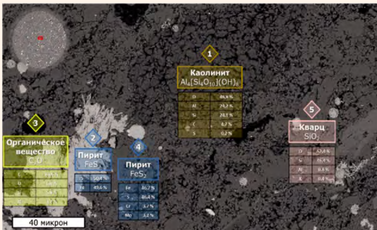
Рис. 6. ЭМ-изображения поверхности образца кремнистого радиоларита с отмеченными точками проведения энергодисперсионного анализа и содержанием элементов в данных точках: 1 – каолинит, 2 – пирит, 3 – органическое вещество, 4 – пирит, 5 – кварц (кремнезем)
