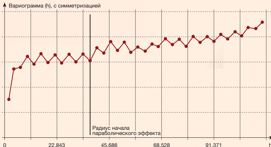
Рис. 1. Ситуация, в которой радиус перерегиба вариограммы действительно ограничивает размеры поискового эллипсоида
