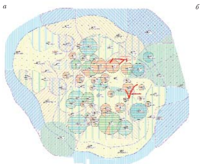
Рис. 3. Ново-Суксинское месторождение: а – карта разработки бобриковского горизонта; б – проектная (показана красным цветом) и фактическая (коричневый цвет) траектории двухзабойной скважины
